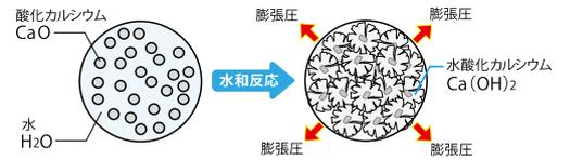
③ この膨張圧によって、孔内には放射状の圧縮応力が発生し、これと直角方向に引張応力が作用します。引張応力が岩石やコンクリートの引張強度を超えたときに、亀裂が生じます。
