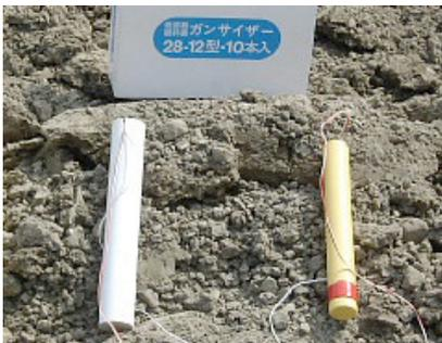
ガンサイザーのみ(右)と弾性波探査用カートリッジを装着した状態(左)
