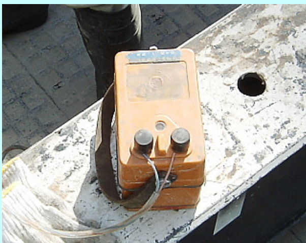
着火器に母線を接続した状態
